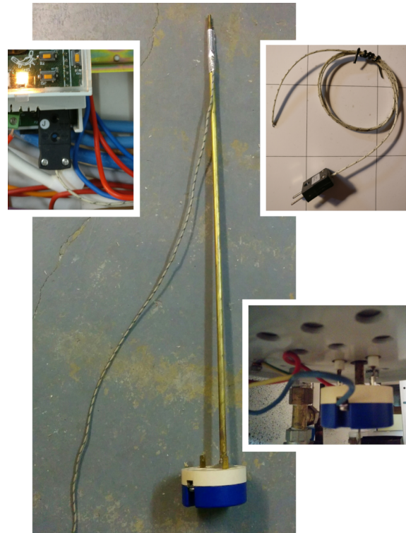
FIG 5 – Exemple de mise en place du thermocouple
